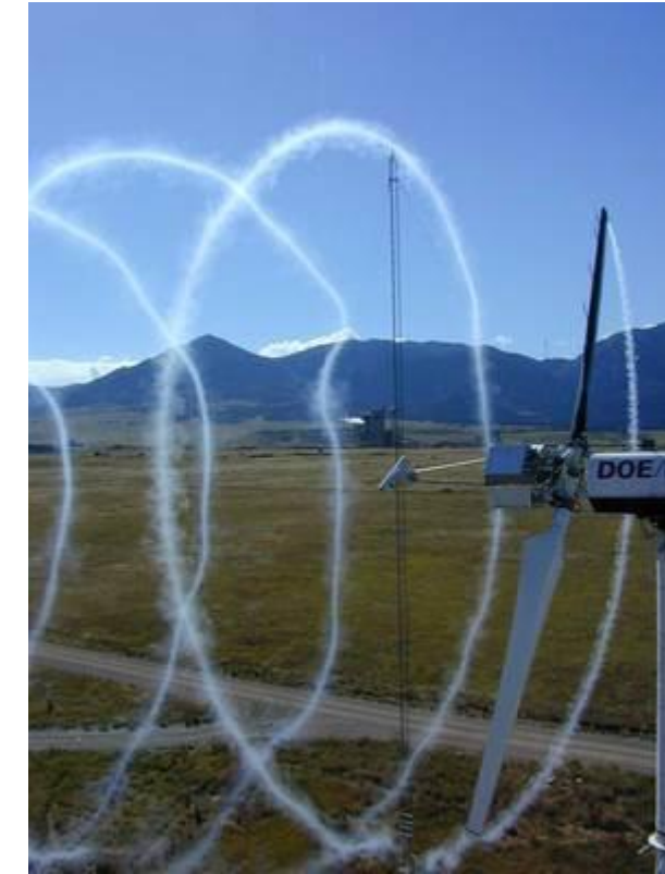
Photographie 19 Effet de sillage derrière une éolienne bi-pale visualisé à l'aide d'un traceur fumée
